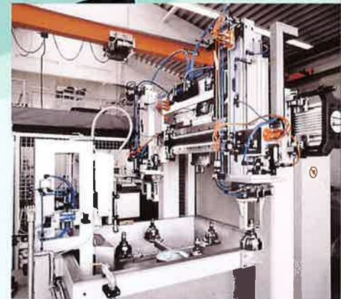
Automatische Beschickung durch Portallader
