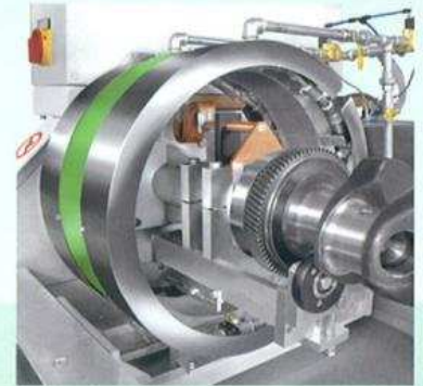
Universal 2650-ACC Zur Prüfung von Groß- gussteilen
