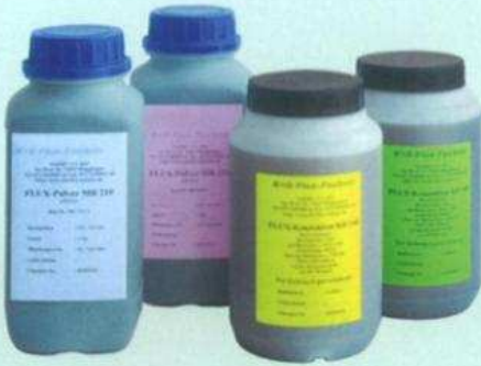
Rissprüfmittel für die Magnetpulver- prüfung
