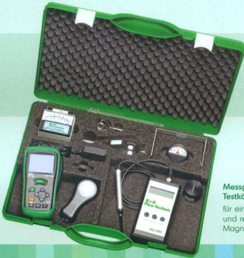
Rissprüfmittel für die Magnetpulver- prüfung
