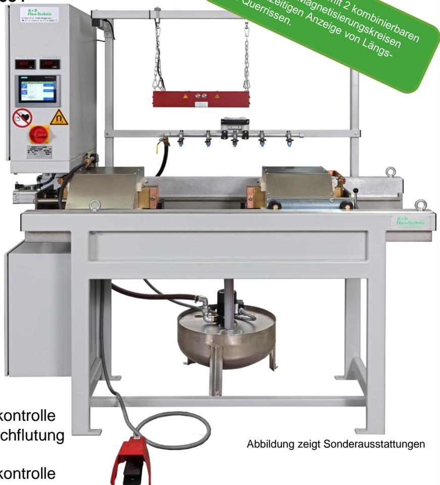
Stationäre Prüfbank mit 2 kombinierbaren Wechselstrom Magnetisierungskreisen zur gleichzeitigen Anzeige von Längs- und Querrissen.
