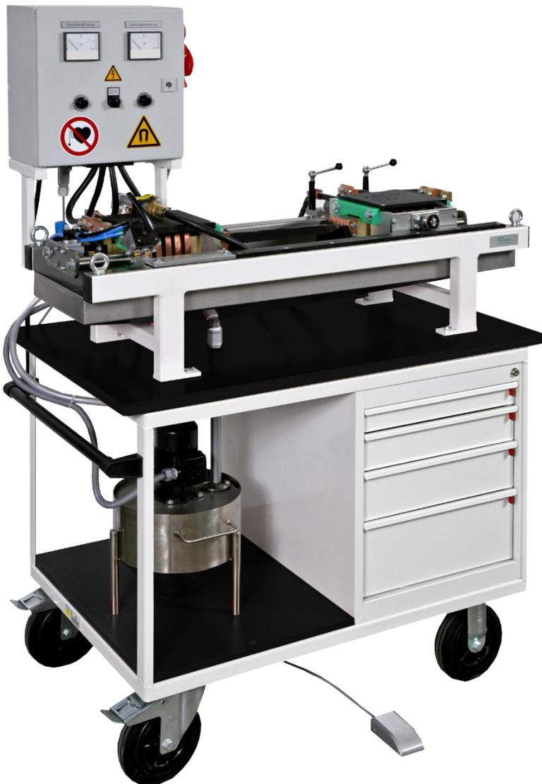
Stationäre Prüfbank mit 2 kombinierbaren Wechselstrom-Magnetisierungskreisen zur gleichzeitigen Anzeige von Längs- und Querrissen, als Tischgerät.
